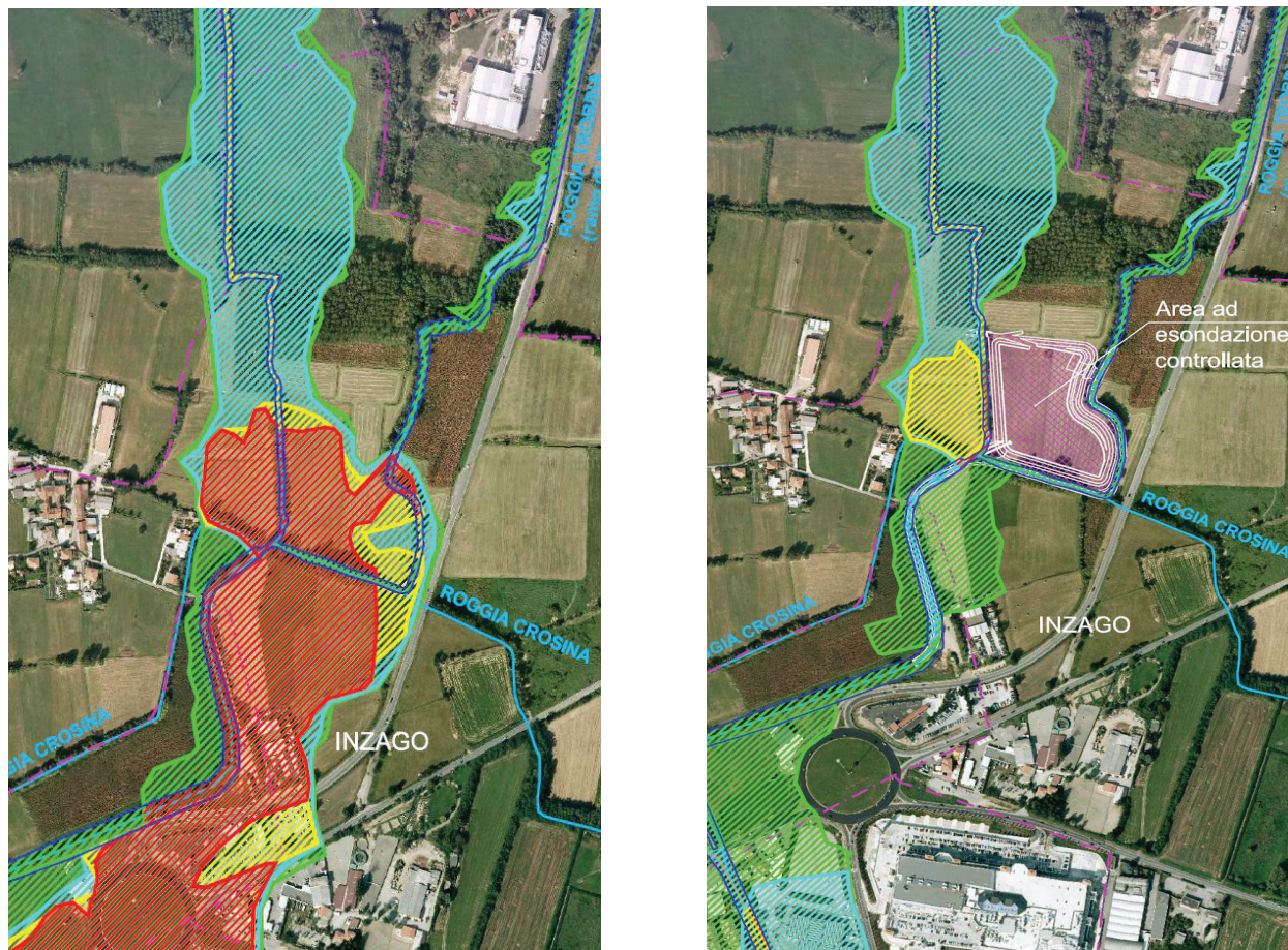
Area di Cascina Pignone / Villa Fornaci – confluenza Rio Vallone e torrente Trobbia, prima (a sinistra) e dopo (a destra) la realizzazione della vasca di laminazione
